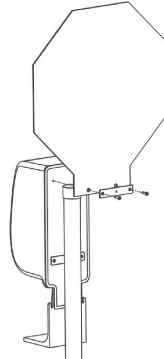
Visser le panneau d'affichage au dos du distributeur de savon en utilisant la plaquette comme le montre le schéma ci-dessus.
