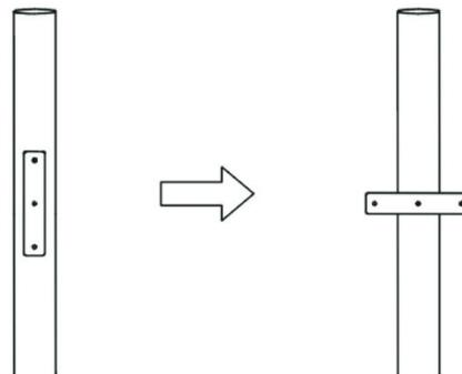
Reperer la plaquette présente sur l'un des tubes et la tourner à 90° comme le montre le schéma ci-dessus.
