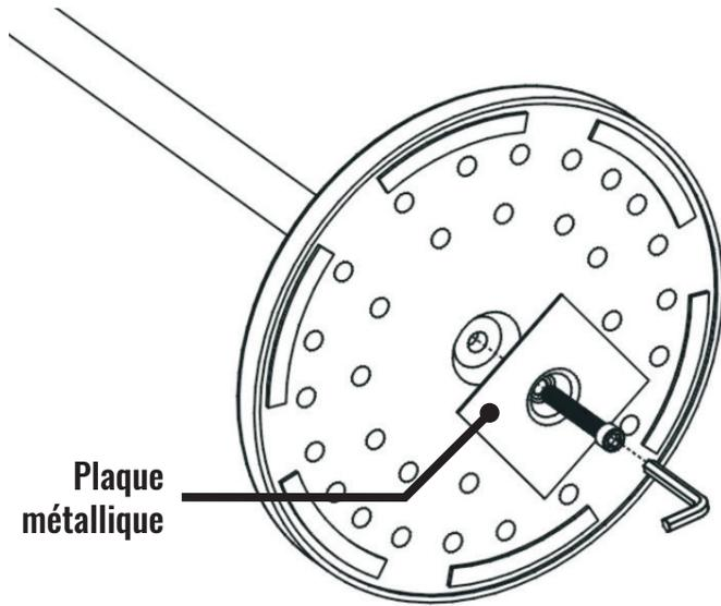
Fixer le socle au support en plaçant la plaque métallique en face du pas de vis situé sous le socle. Utiliser la plus grosse vis hexagonale pour fixer le tout
