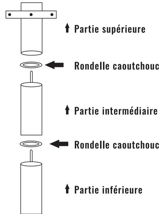
Assembler les 3 tubes en les vissant les uns aux autres, ne pas oublier les rondelles caoutchouc entre chacun d'entre eux.
