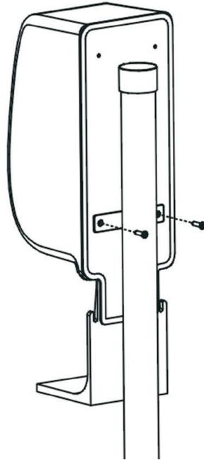
Installer le distributeur de savon à l'ensemble en le vissant à la plaquette avec deux vis
